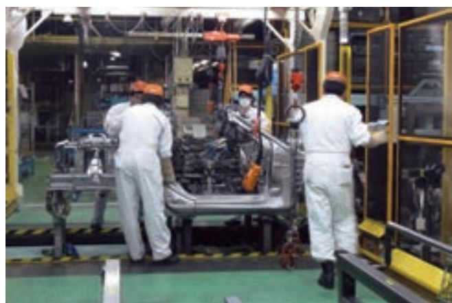
インナー治具工法により実現するスポーツカーとしての高剛性ボディ High-rigidity body for sports cars realized using the inner jig method
